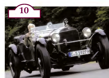
M-Benz „SS“ Rennsport Bj. 1929 · 7200 ccm · 6 Zyl. · 180 PS mit Kompressor 225 PS FRANZ MAAG FRANZ BISCHOFF
