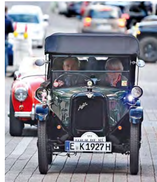
Der Austin A7 von 1927 ist das drittälteste Fahrzeug bei der diesjährigen Tour de Rü. Der Wagen hat eine längsgeteilte Frontscheibe, die oben hochgeklappt werden kann. Er trägt die Startnummer 99.
